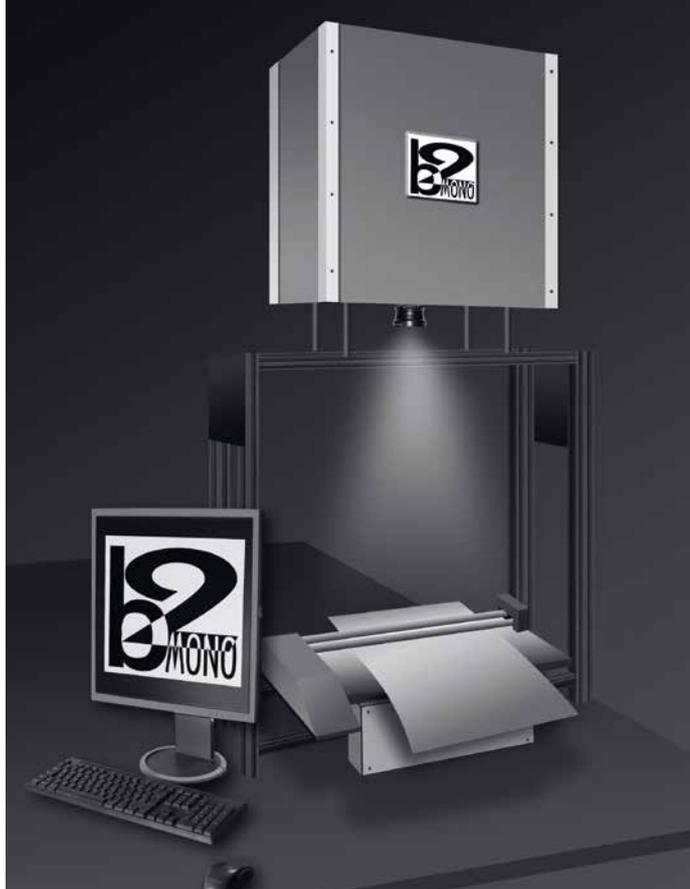
▲ *Anders als beim klassischen Vergrößerer wird beim B2-Mono zeilenweise belichtet, das heißt das unten sichtbare, lichtempfindliche Fotopapier wird synchron mit der Belichtung geführt*
