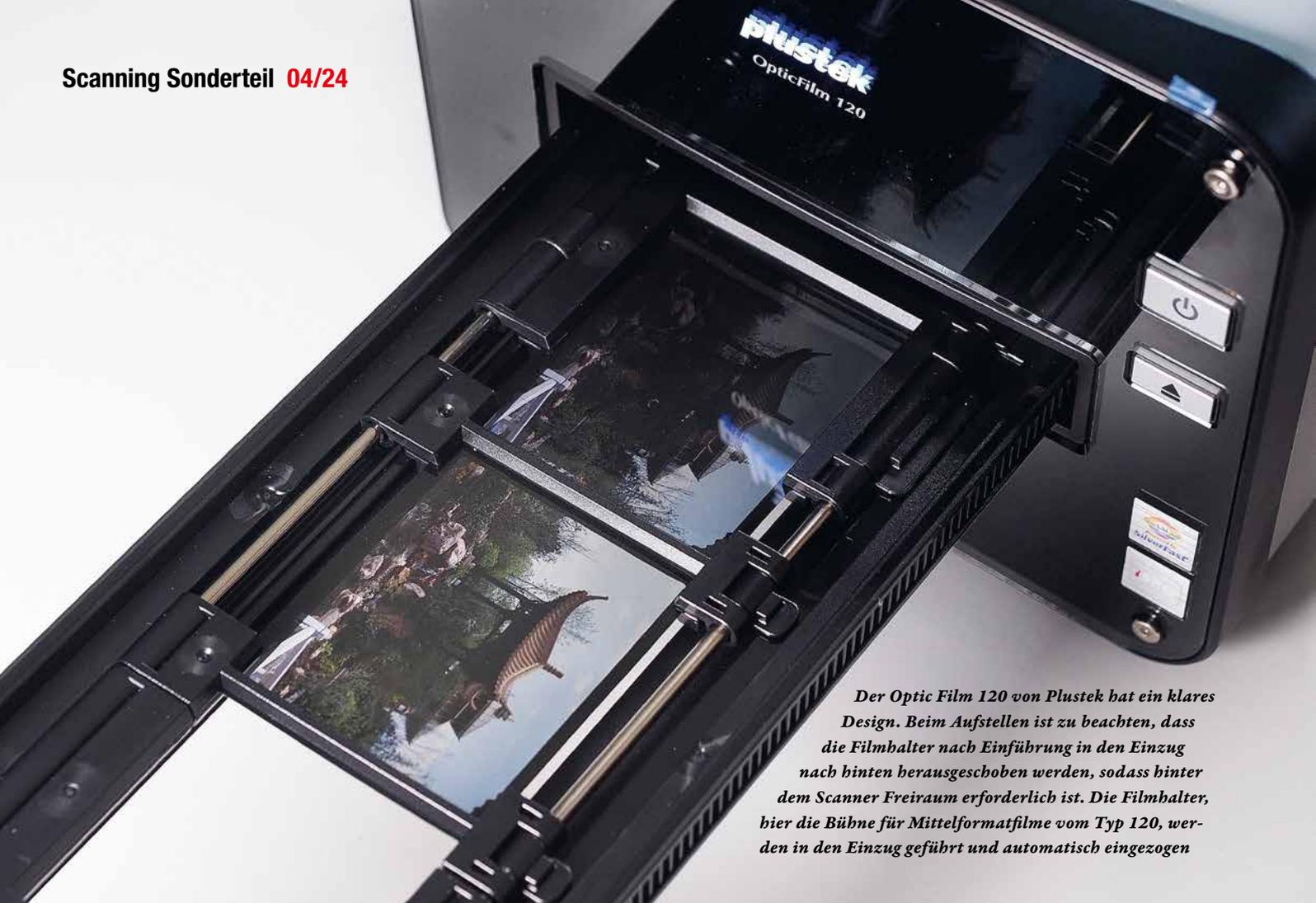
*Der Optic Film 120 von Plustek hat ein klares Design. Beim Aufstellen ist zu beachten, dass die Filmhalter nach Einführung in den Einzug nach hinten herausgeschoben werden, sodass hinter dem Scanner Freiraum erforderlich ist. Die Filmhalter, hier die Bühne für Mittelformatfilme vom Typ 120, werden in den Einzug geführt und automatisch eingezogen*
