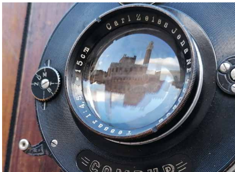
▲ Das Tessar von Zeiss mit Lichtstärke 4,5 und 15 cm Brennweite leistet in Kombination mit dem Compur-Verschluss noch immer beste Dienste, auch in Siena
