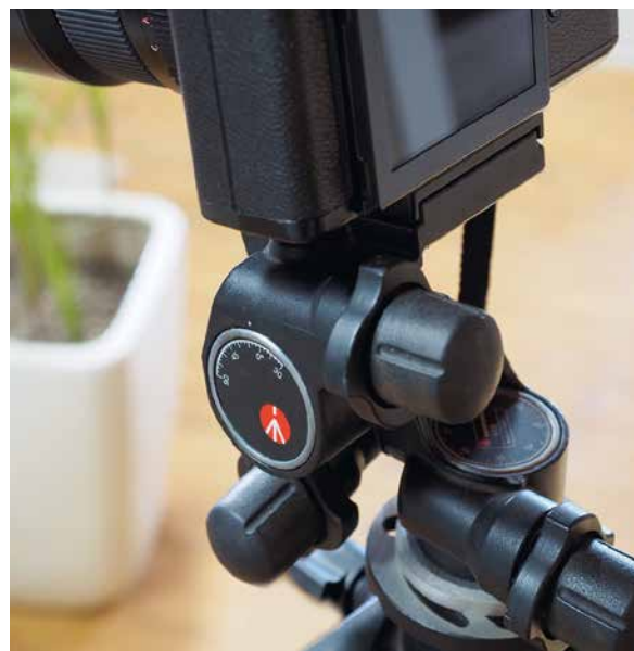
▲ Ideal sind 3D-Getriebeneiger, wie etwa dieser von Manfrotto, mit einer Gradskala für das kontrollierte Neigen der Kamera
