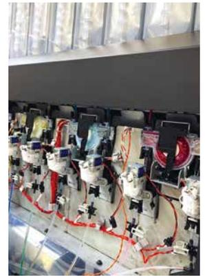
▲Alle Farben. Blick unter das Gehäuse des umgebauten Mimaki-Druckers auf die Tintenzuleitungen
