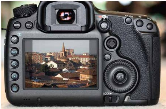
▲ *Das Kameradisplay maskiert mit der semi-transparenten Folie und dem Bildausschnitt im Seitenverhältnis 7:6. So sehen Sie auch, was sich links und rechts des maskierten Formats befindet*
