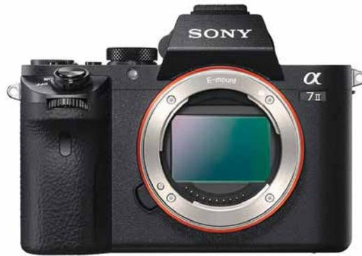
▲ **Sony A7 II:** Vollformatsensor (36 x 24 mm), 24,3 Megapixel, Systemkamera mit Wechselobjektiven, Gewicht 599 g, Maße ca. 12,7 x 9,6 x 6 cm
