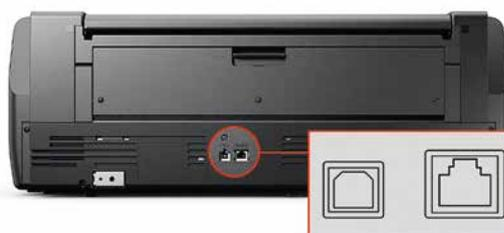
◀ Die Anschlüsse des Epson SC-PS00 befinden sich auf der Rückseite. Links der USB- und rechts daneben der Ethernet-Anschluss
