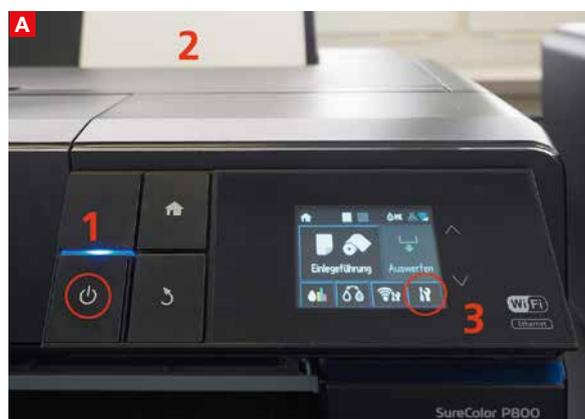
**A** Schalten Sie den Drucker ein (1). Legen Sie für den Düsentest ein ganz gewöhnliches Kopierpapier in die automatische Papierzufuhr (2). Anschließend auf dem Display (3) auf das Setup-Icon klicken.
