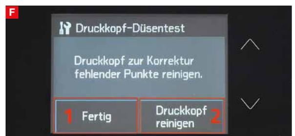
**F** Wenn das Linienmuster ok ist, drücken Sie auf den Button „Fertig“ (1). Hat das Muster Unterbrechungen, ist eine Reinigung erforderlich. Drücken Sie
