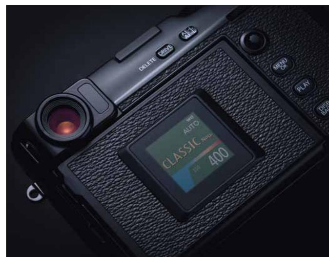
▲ Das rückwärtige Klappdisplay der X-Pro3 ist mit einem zusätzlichen Infodisplay in Filmfenstergröße bestückt, auf dem die jüngsten Kameraeinstellungen erkennbar sind. Auch wenn die Kamera ausgeschaltet ist
