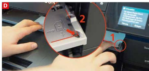
D Legen Sie das Blatt in die Einzelblattzufuhr (1). Positionieren Sie die rechte untere Papierecke genau im Eckpunkt wie in der Abbildung (2).
