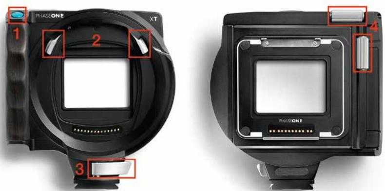
▲ Die Bedienelemente der Phase One XT: Der blaue Auslöseknopf (1) aktiviert durch leichtes Antippen die Liveview-Ansicht. Durch Drücken der beiden Hebel (2) lässt sich das Objektiv wechseln. Der Wechsel von Quer- zu Hochformat geschieht durch Entriegeln der Festklemme (3). Mit den Rändelrädern (4) kann das Digitalrückteil vertikal und horizontal verschoben werden
